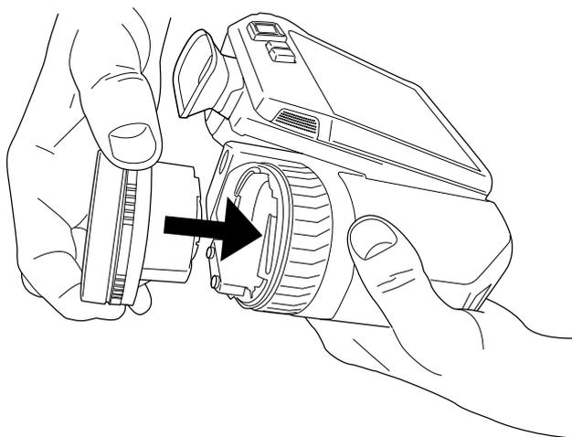
6. Faites pivoter l'anneau intérieur à 30° dans le sens horaire. L'objectif émet un déclic lorsqu'il est verrouillé dans son emplacement.
