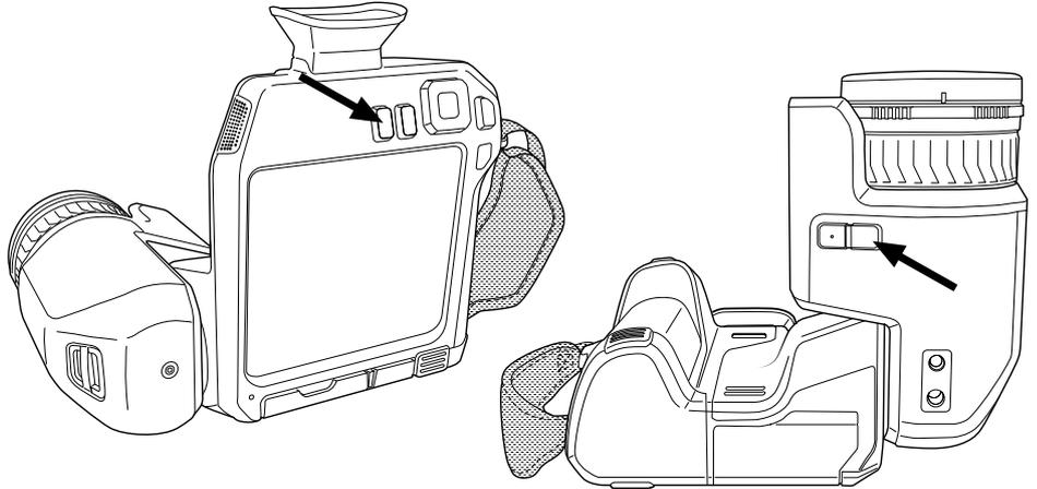
La caméra dispose de deux boutons programmables séparément : l'un au-dessus de l'écran et l'autre sous le boîtier optique.
