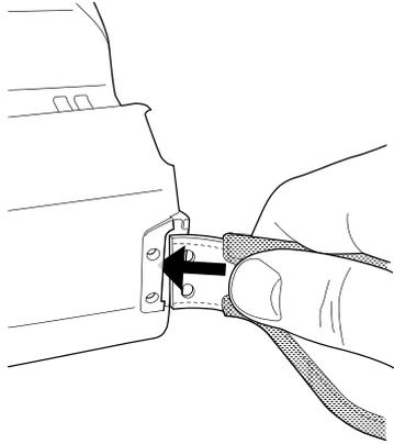
6. Appuyez sur le support de façon à l'insérer dans la caméra. Assurez-vous que les deux trous de la dragonne sont alignés avec les trous du support.
